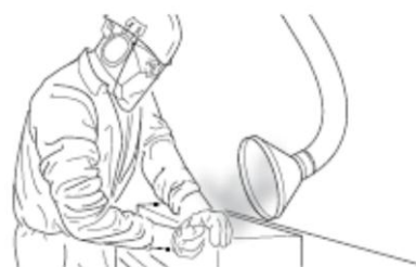
کار بر روی سطح قطعه: اطمینان از نزدیکی هود به سطح کار
