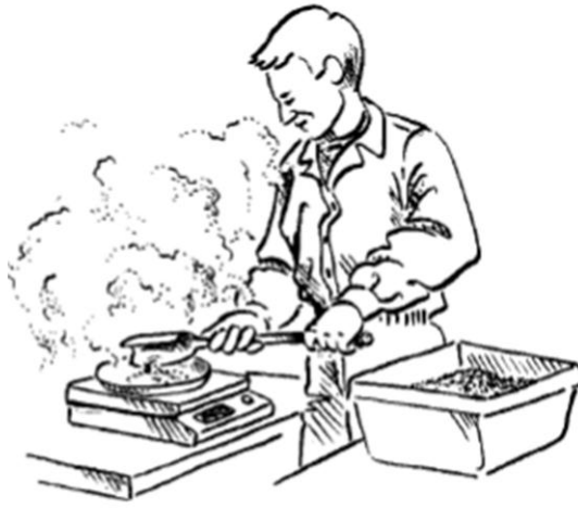
قبل: انتشار گرد و غبار در ایستگاه توزین رنگ میکرونیزه حاوی سرب
